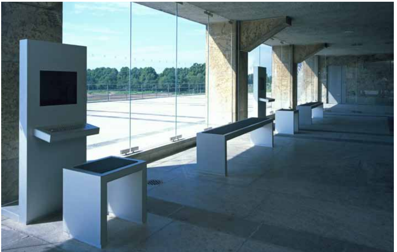
Alu-Paneel mit aufgeklebter Bildfolie und Möbel aus anodisiertem Aluminiumblech
